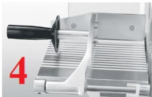
4. По окончании работы поверните ручку регулятора толщины нарезки в положение «0», отключите оборудование при помощи сетевого выключателя, снимите продукт с каретки и соберите ломтики продукта.
